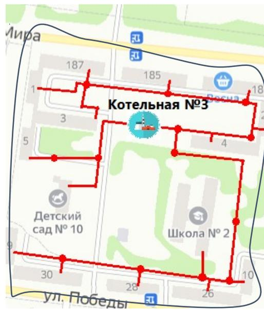
Рисунок 1.4.3 - Зона действия котельной №3.
