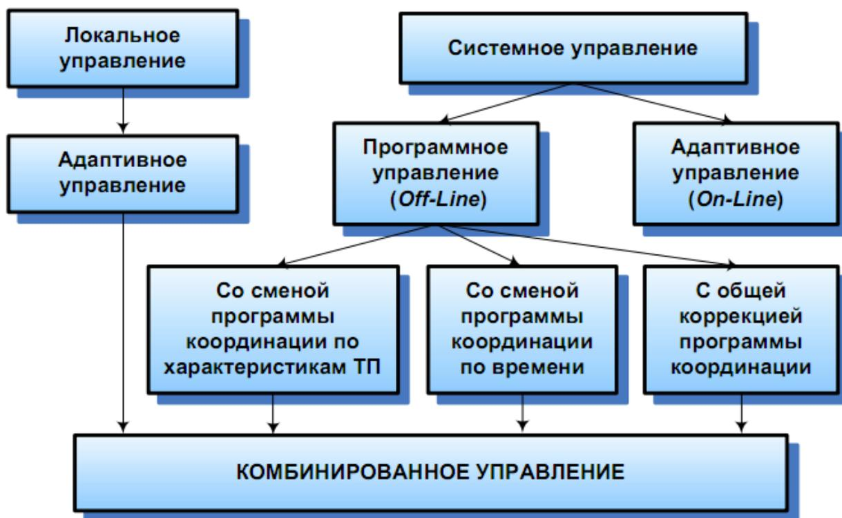
Рисунок. Классификация методов управления транспортными потоками
