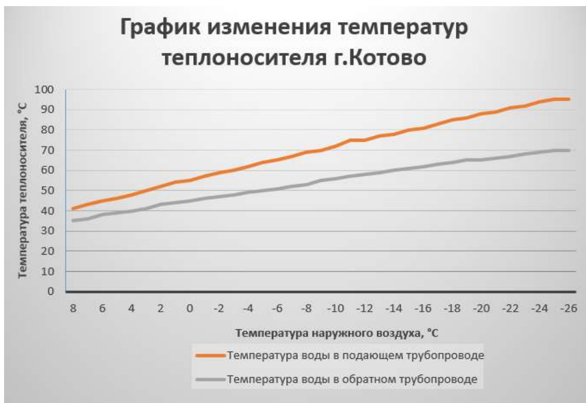
Рисунок 5.8.1.– График изменения температур теплоносителя 95–70 °С.
